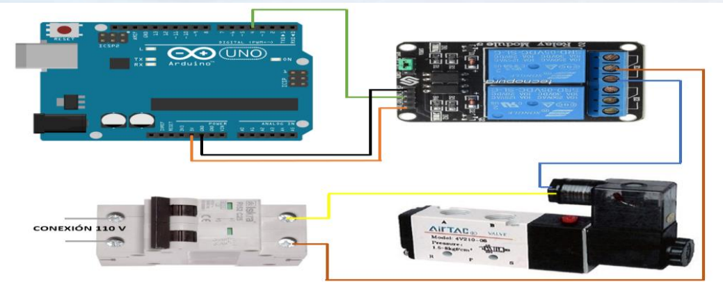
COMPONENTES ELÉCTRICOS DEL SISTEMA
