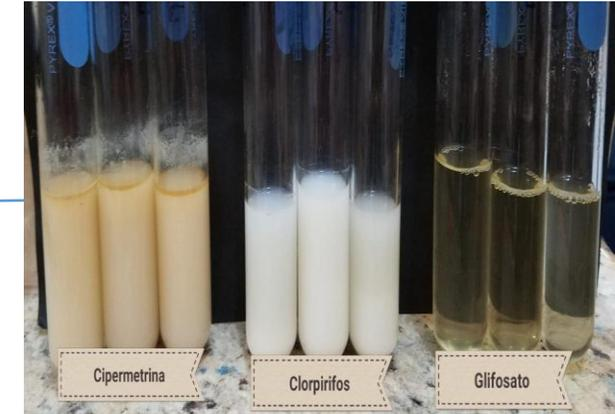
Siembra de preinoculo en medio mineral contaminado de piretroide (cipermetrina), organosforado (clorpirifos) y N (fosfometil) glicina (glifosato).
