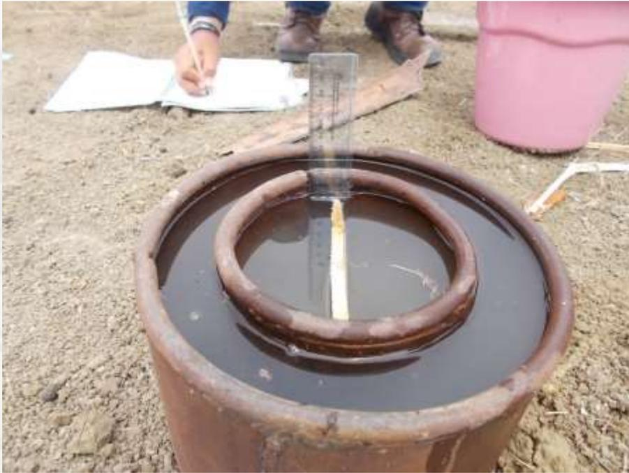
Foto N°5. Midiendo la velocidad de infiltración en el suelo.
