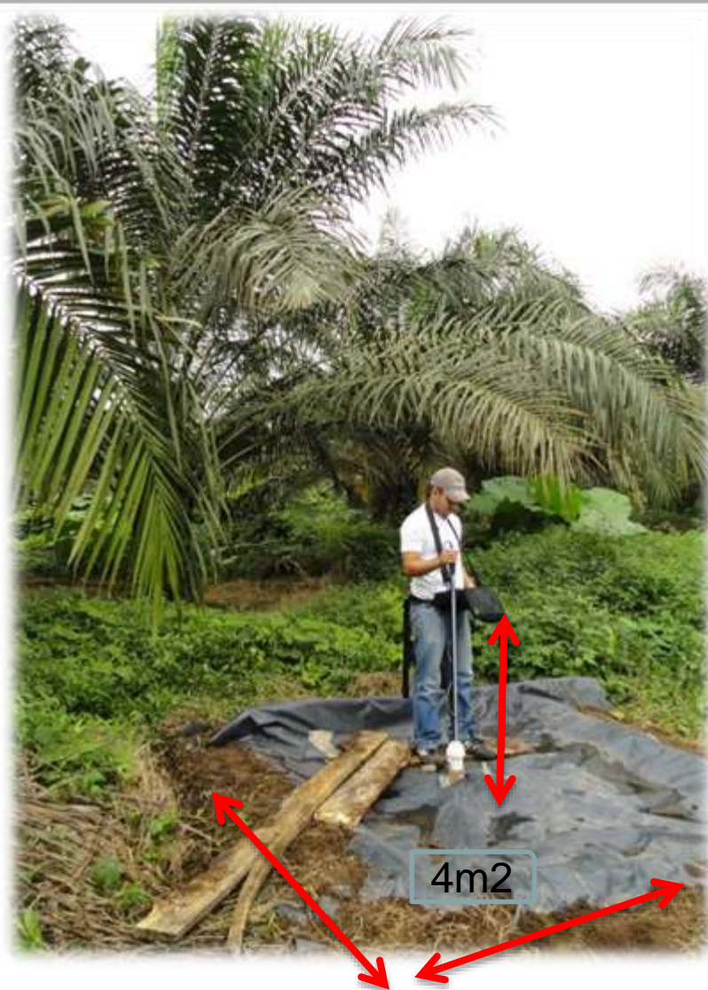
Figura 5. Introducción de la sonda del DIVINER 2000, para la toma de datos. CIPAL, 2010.
