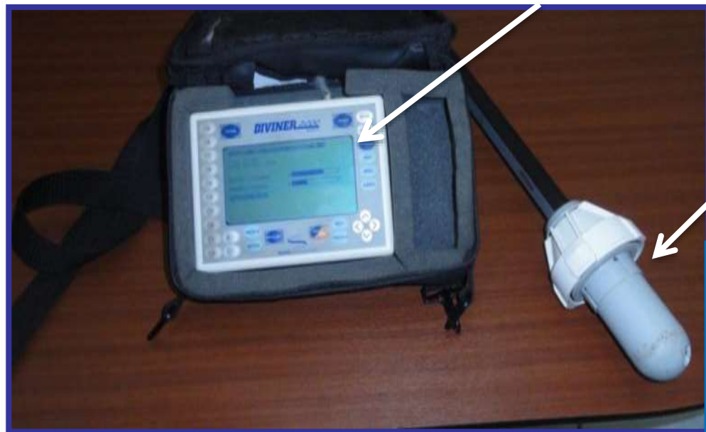
Figura 3. Consola y sonda DIVINER 2000. CIPAL, 2010.
