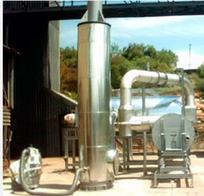
Este pirolizador de flujo continuo de Pro Natura hace biochar para granjas en Senegal
