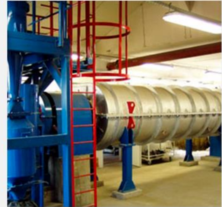
Este reactor de pirólisis rotativa de 3R Agrocarbon produce biochar y gas de síntesis.
