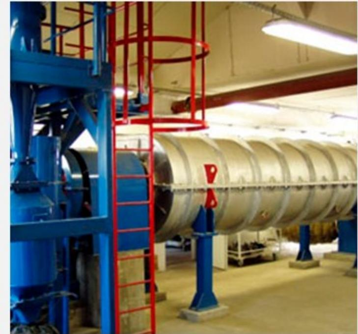
Este reactor de pirólisis rotativa de 3R Agrocárbón produce biochar y gas de síntesis.
